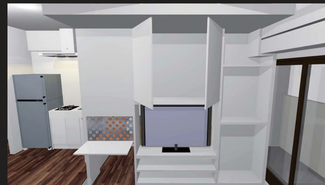
可動棚(裏:開) 左:テーブル 中上:収納 中:TV棚(360°回転) 右:棚(扉取り付け可能)
